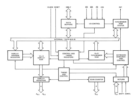
FIGURE 1. 8279 BLOCK DIAGRAM
