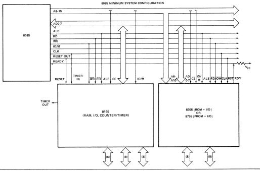
FIGURE 7. MCS-85™ MINIMUM SYSTEM (MEMORY MAPPED I/O)
