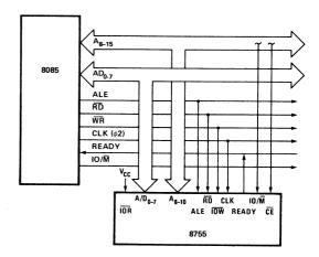
FIGURE 2. 8755 IN 8085 SYSTEM (STANDARD I/O).
