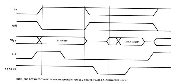
FIGURE 1. MEMORY READ/WRITE CYCLE.
