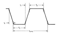
FIGURE 3. CLOCK SPECIFICATION FOR 8755
