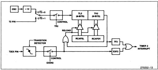
Figure 13. Timer 2 in Auto-Reload Mode
