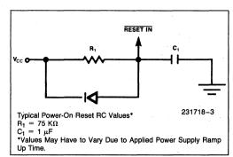
Figure 3. Power-On Reset Circuit
