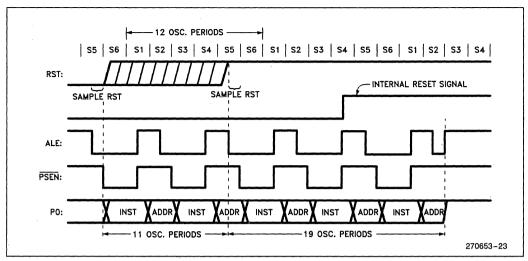
Figure 26. Reset Timing
