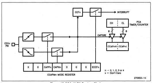
Figure 17. PCA 16-Bit Capture Mode
