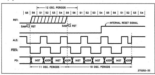
Figure 25. Reset Timing
