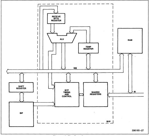
Figure 15. The Byte Processor
