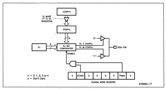
Figure 20. PCA 8-Bit PWM Mode
