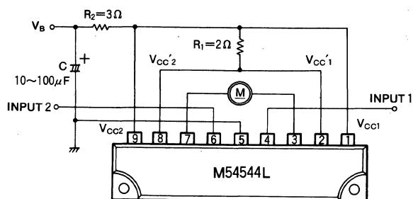
2) MOTOR SPEED CONTROL BY THE  $V_{cc}'$
