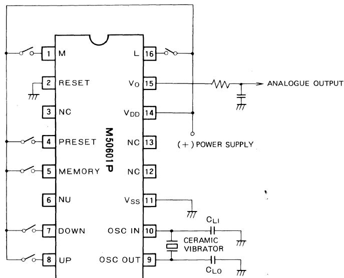
**ELECTRONIC VOLUME CONTROL CMOS 5-BIT D/A CONVERTER**
