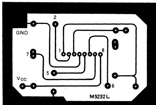
PCB DIAGRAM (COPPER FOIL SIDE)
