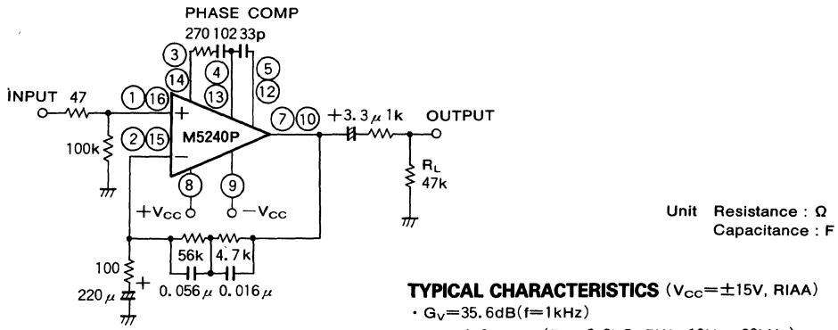
**TYPICAL CHARACTERISTICS** ( $V_{CC}=\pm 15\text{V}$ , RIAA)
