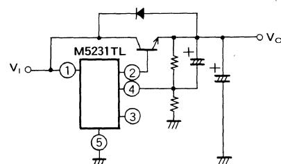
**VARIABLE OUTPUT VOLTAGE REGULATOR(DUAL TRACKING TYPE)****DESCRIPTION**
