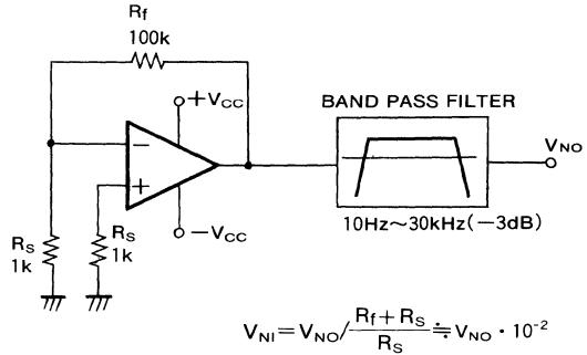
$$V_{NI} = V_{NO} / \frac{R_f + R_s}{R_s} \doteq V_{NO} \cdot 10^{-2}$$
