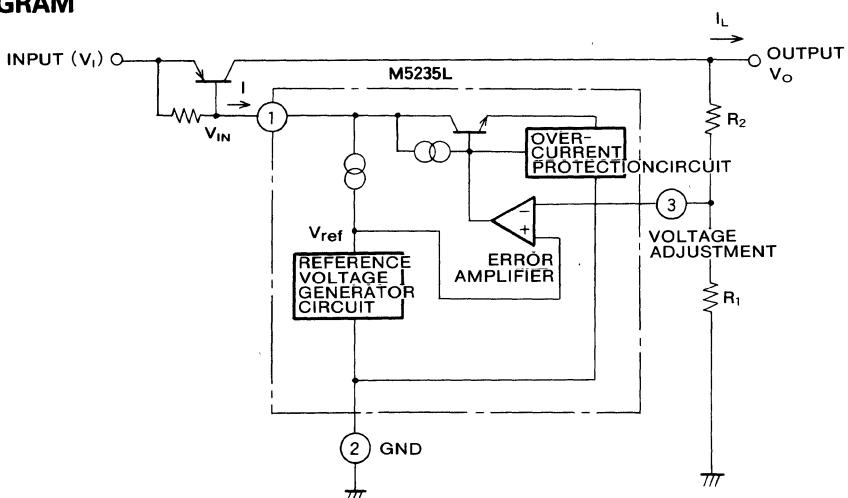
**3V,3-TERMINAL VARIABLE VOLTAGE OUTPUT REGULATOR (FOR DRIVER)****ABSOLUTE MAXIMUM RATINGS ( $T_a=25^\circ\text{C}$ )**
