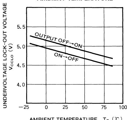
UNDERVOLTAGE LOCK-OUT VOLTAGE  $V_{CCLO}$  (V)
