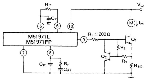
$$I_{M\max} = (V_{BE2} - V_{BE1}) \times \frac{R_3}{R_2 + R_3} / R_{SC}$$
