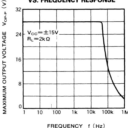
DUAL LOW-NOISE OPERATIONAL AMPLIFIERS (DUAL POWER SUPPLY TYPE)
