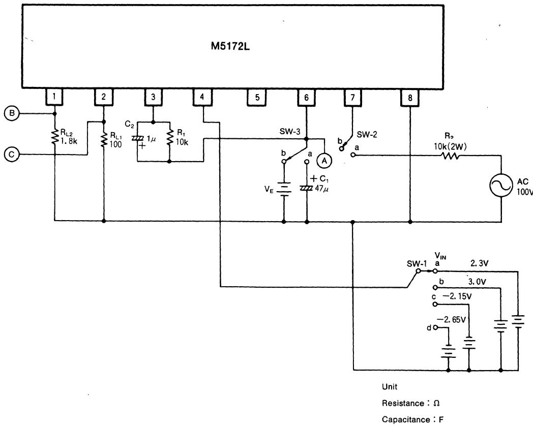
ZERO-POINT IGNITION TEMPERATURE CONTROL CIRCUIT
