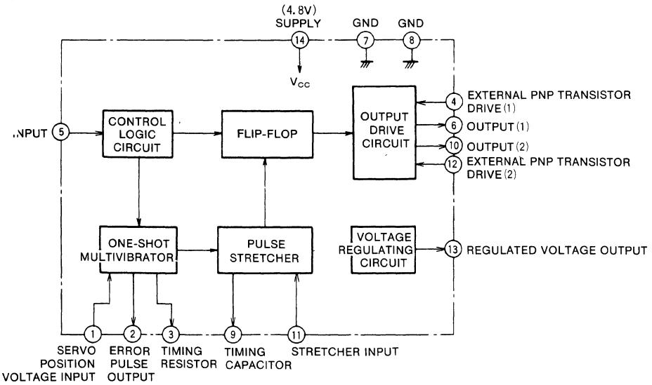
SERVO MOTOR CONTROL FOR RADIO CONTROL
