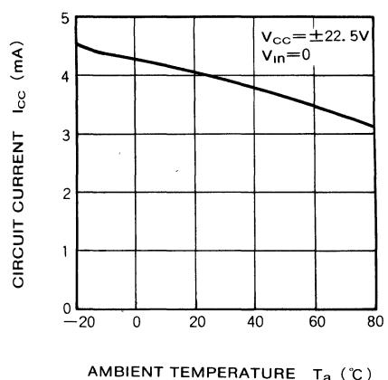
DUAL LOW-NOISE OPERATIONAL AMPLIFIERS(DUAL POWER SUPPLY TYPE)
