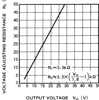
VARIABLE OUTPUT VOLTAGE REGULATOR(DUAL TRACKING TYPE)
