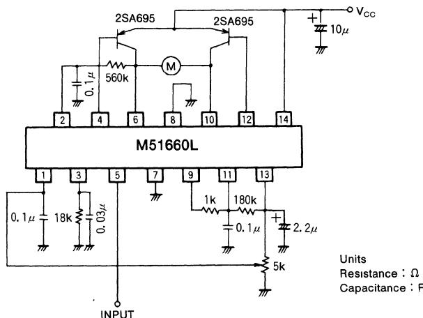
SERVO MOTOR CONTROL FOR RADIO CONTROL
