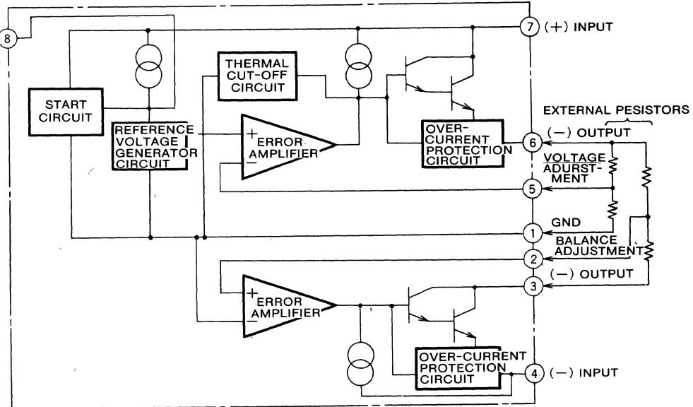
VARIABLE OUTPUT VOLTAGE REGULATOR(DUAL TRACKING TYPE)
