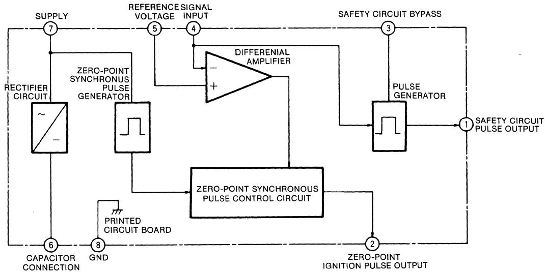
ZERO-POINT IGNITION TEMPERATURE CONTROL CIRCUIT
