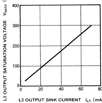
**AO OUTPUT SATURATION VOLTAGE VS. SINK CURRENT**
