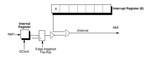
Figure 6-27 VR5432 Nonmaskable Interrupt Signal
