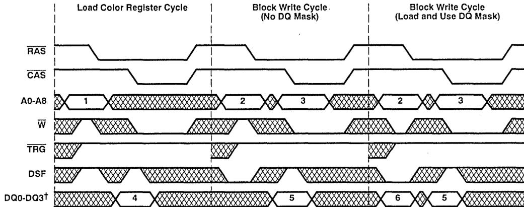
† DQ0-DQ3 ( $\overline{\text{CAS}}$ ) are latched on the later of  $\overline{\text{W}}$  or  $\overline{\text{CAS}}$  falling edge. DQ0-DQ3 ( $\overline{\text{RAS}}$ ) are latched on  $\overline{\text{RAS}}$  falling edge.
