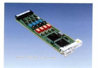
Fig. 10-DS1s channel unit (LSCH-D1).
