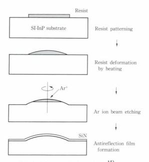
Fig. 5-InP microlens fabrication<sup>14)</sup>.
