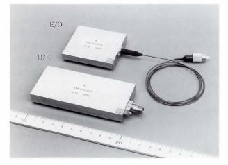
Fig. 17-OC-3 1.55 µm E/O, O/E module.
