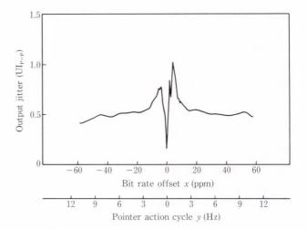
Fig. 9-DS1 bit-synchronous output jitter.
