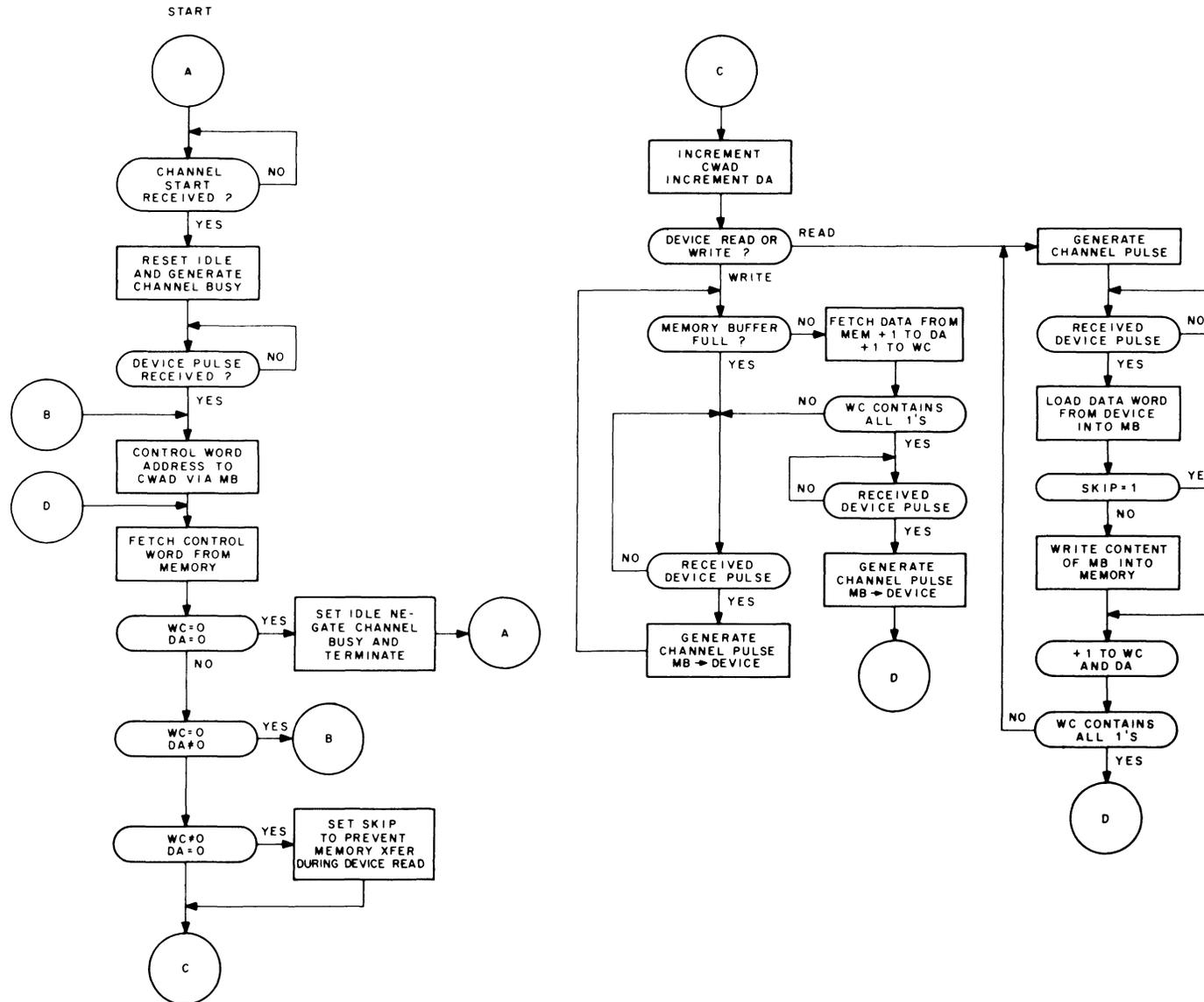
Figure 4-2 DF10 Flow Diagram
