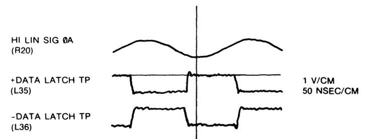
FIGURE 3-70. BIDIRECTIONAL ONE SHOT, DATA LATCH
