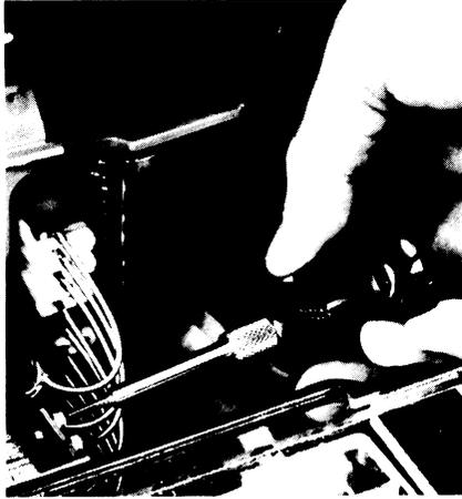
FIGURE 4-9. USING HEAD TORQUE TOOL
